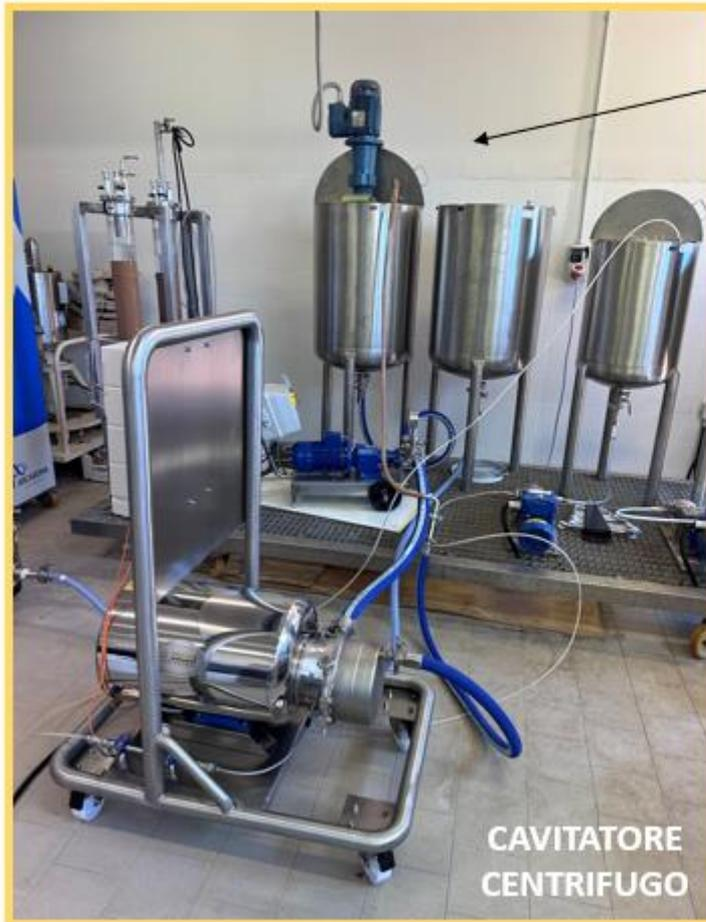
Serbatoio con solvente (acqua) e matrice vegetale (1:10 p/v)
