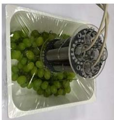
SAIM HA REALIZZATO UN PROTOTIPO PER LA PRODUZIONE DI OZONO GASSOSO AD ALTA CONCENTRAZIONE DIRETTAMENTE ALL'INTERNO DI CONFEZIONI CHIUSE
